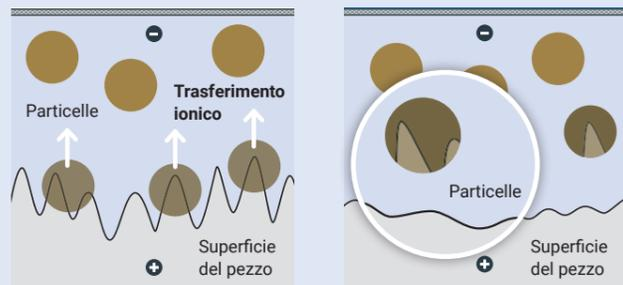
La base è una sospensione appositamente sviluppata composta da particelle funzionali e liquidi ionici contenuta nel contenitore di lavoro in cui si introduce il pezzo. La creazione di una sorgente di corrente definita crea un potenziale elettrico tra il catodo (-) e l'anodo/pezzo (+).
