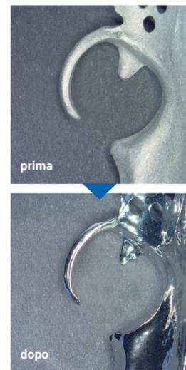
La lavorazione avviene fin nelle aree a maggiore profondità del pezzo, anche con geometrie difficili, senza ripercussioni sulla struttura di base.
