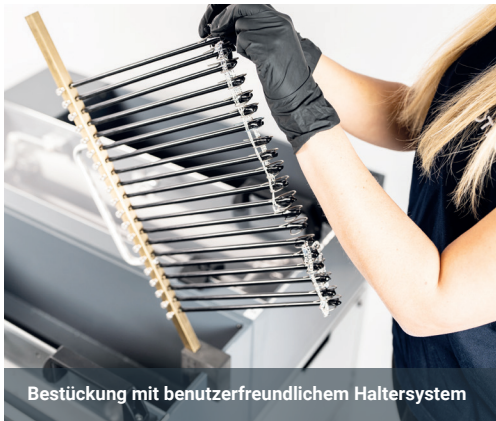
Bis zu 40 Werkstücke pro Arbeitsbehälter
