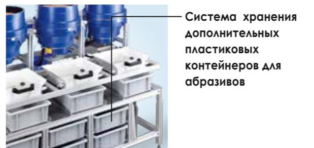
Система хранения дополнительных пластиковых контейнеров для абразивов
