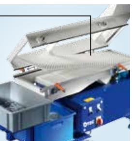
**Автоматическое разделение с интегрированным размагничивающим устройством**
