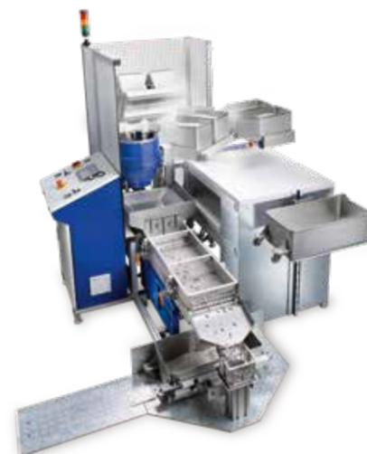
La macchina CF 50 MR è dotata di un dispositivo automatico di filtraggio e di un sistema di riciclo dei materiali di levigatura. Svuotando il buratto, i pezzi vengono filtrati automaticamente. Grazie all'oscillazione all'indietro, il materiale di levigatura viene ricondotto nel buratto ed è possibile sostituirlo cambiando l'apposito contenitore. Inoltre, un meccanismo particolarmente ingegnoso permette di sostituire rapidamente e in modo semplice il filtro senza bisogno di utensili.
