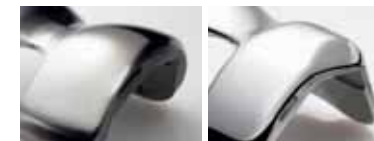
Пример: отполированная поверхность, Ra 0.01 \mu m
