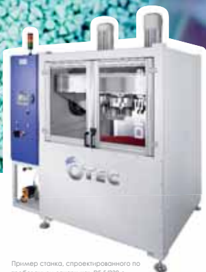
Пример станка, спроектированного по требованиям заказчика: DF 5/330 с диаметром барабана 1100 мм
