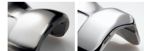
Příklad: vysoce leštěný povrch, Ra 0,01 μm
