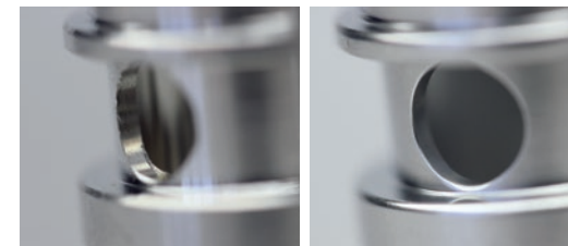
Příklad: před procesem s otřepy, po kompletním začištění
