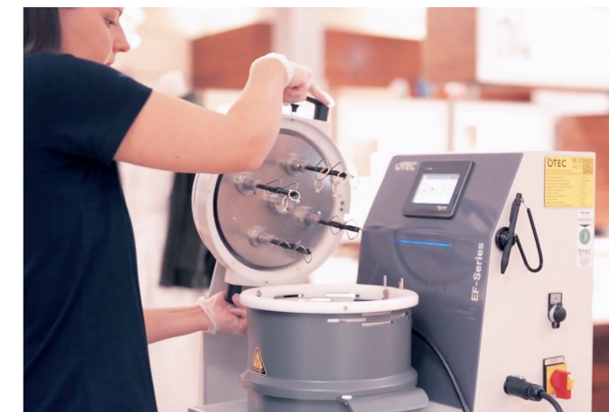
Der Deckel wird anschließend auf dem Behälter fixiert
