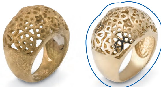
L'électropolissage garantit des surfaces parfaites dans les interstices les plus minuscules.
