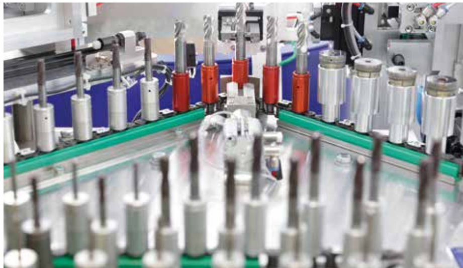
Mit Werkzeugen bestückter Kettenlader der SF ILS
