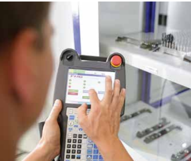
Touchpanel zur Steuerung des Roboterarms der SF RLS
