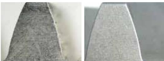
Exemple : profil d'engrenage avant et après traitement
