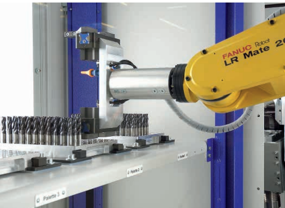
Роботизированная рука захватывает фрезу с поддона
