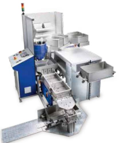
Die CF 50 MR ist mit einer automatischen Siebeinrichtung und einer Schleifkörper-Rückführung ausgestattet. Beim Entleeren des Arbeitsbehälters werden die Werkstücke automatisch ausgesiebt. Durch das Zurückschwenken werden die Schleifkörper in den Arbeitsbehälter zurückgeführt. Über einen wechselbaren Sammelbehälter können die Schleifkörper auf einfache Weise ausgetauscht werden. Ein ausgeklügelter Mechanismus erlaubt es, das Sieb schnell und einfach ohne Werkzeug zu wechseln.
