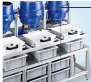
Einrichtung zur Lagerung zusätzlicher Kunststoffbehälter für Verfahrensmittel
