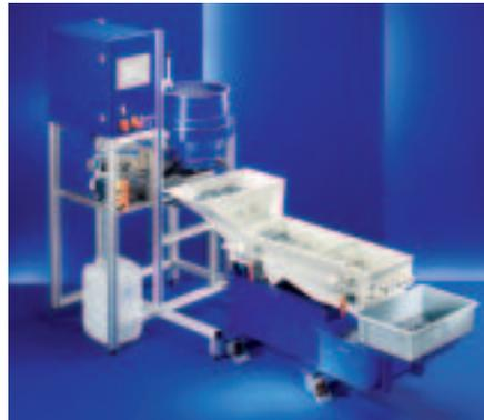
Tellerfliehkraftanlage CF mit Unisepa
